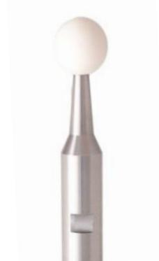
Einachsenmessbahn - Längenmessgerät
